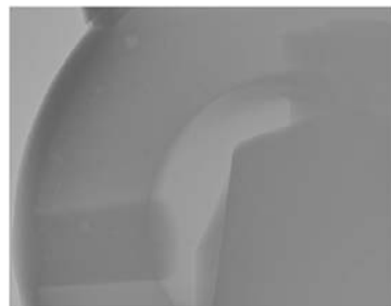
图9 泵体下法兰蜗流道处X射线检测
