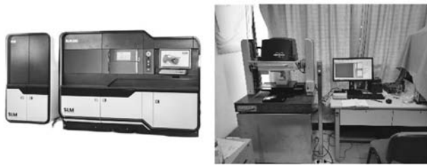
(a) 金属3D打印机 (b) 白光干涉轮廓仪
