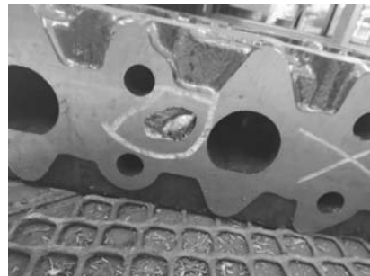
图1 气缸盖局部缺陷
