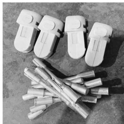
图2 碗头挂板铸件和附铸试棒实物图
