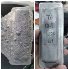
左为普通压铸件右为半固态铸件
