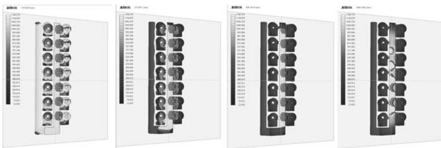
(a) 凝固时间116 s (b) 凝固时间273 s (c) 凝固时间506 s (d) 凝固时间1 006 s
